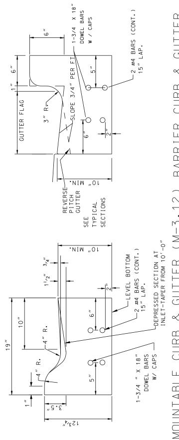
BARRIER CURB & GUTTER (M-3.12)MOUNTABLE CURB
